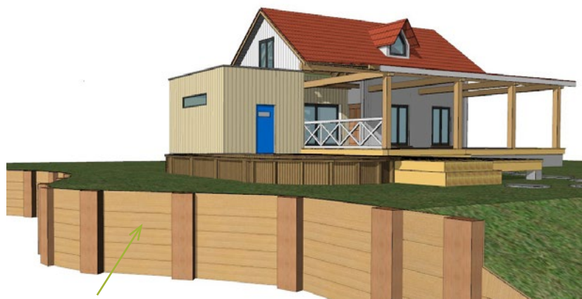
Retenciones de tierra (4)
